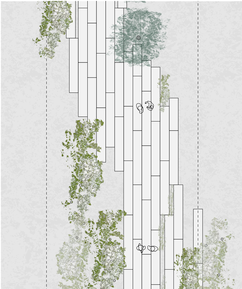
Weg ‚Innerer Garten‘ mit Betonplatten
